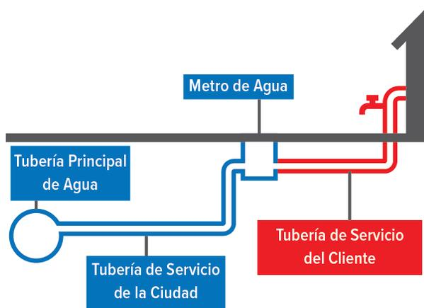
notificación porque nuestros registros históricos no pueden confirmar el tipo de material de la parte de propiedad del servicio público de su tubería de servicio de agua (que se muestra en azul). **Dado que se desconoce el material de la tubería de servicio de agua existe la posibilidad de que parte de ella, o toda, pueda estar hecha de plomo o tuberías galvanizadas que anteriormente se conectaban con plomo y, por lo tanto, deben reemplazarse.**
